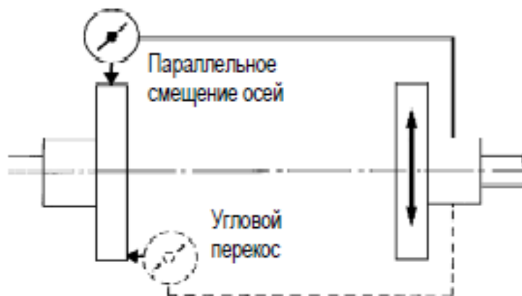
Рисунок 3 – Установка стрелочного индикатора
