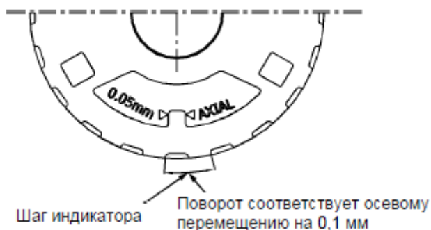
Рисунок 13 – Осевое перемещение рабочего колеса
